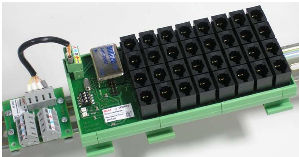
Рисунок 10 – Подключение модуля индикации MI41 к клеммнику питания/связи UN1
