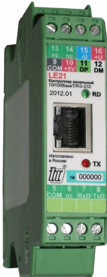
Рисунок 1 – Внешний вид контроллера LE21
